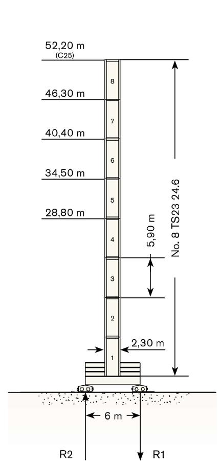
Max. under hook height · Höchstes Hakenhöhe · Hauteur maxi. sous crochet · Maxima altura bajo gancho · Altezza max. sotto gancio
